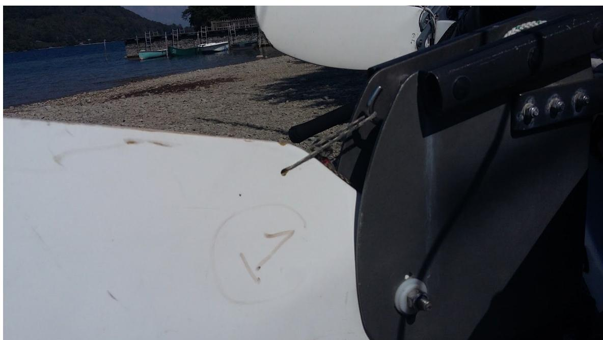
On va utiliser du mastic armé pour refaire la structure du safran , puis du mastic de finition et du Gelcoat pour refaire l'état de surface.
