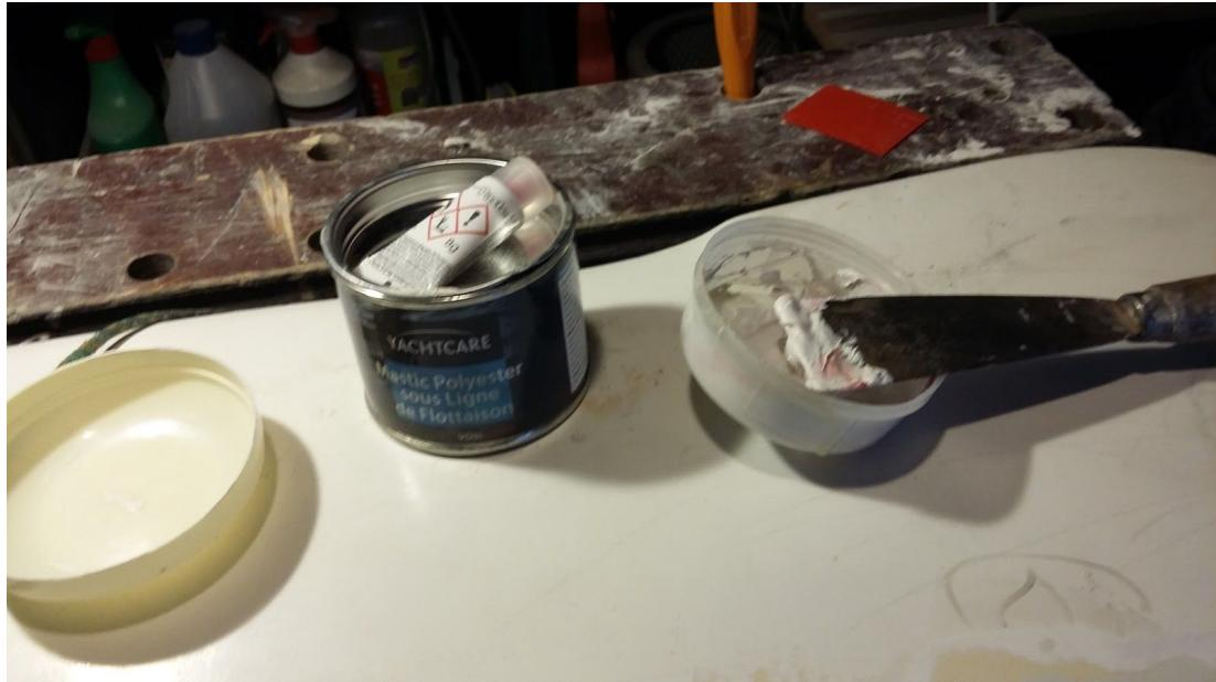
Ici aussi le temps de séchage est court. Une fois sec, on peut poncer le mastic de finition au papier à l'eau (180 puis 360). (voir la technique pour le ponçage à l'eau dans le paragraphe du Gelcoat.
