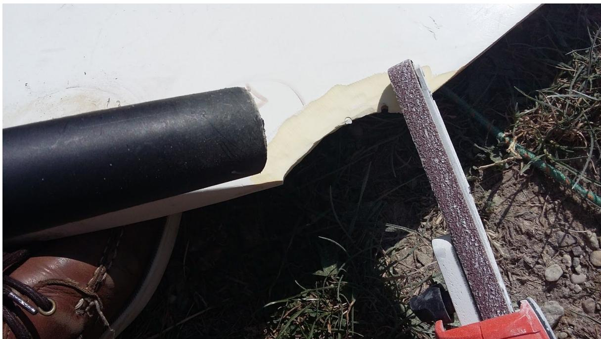
Une fois la surface du safran poncée, il faut préparer un support pour pouvoir déposer du mastic dans le prolongement du bord du safran. On utilise pour cela une petite planchette en bois que l'on a recouvert de film plastique pour que le mastic n'accroche pas dessus :
